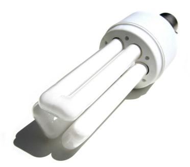
La lampada fluorescente è un particolare tipo di lampada a scarica in cui l'emissione luminosa visibile è indiretta, ovvero non è emessa direttamente dal gas ionizzato, ma da un materiale fluorescente (da cui il nome).
