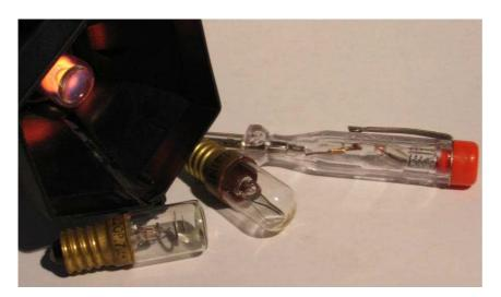
La lampada al neon è un tipo di lampada a scarica costituita da un bulbo di vetro trasparente contenente gas neon a bassa pressione.
