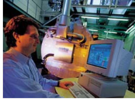
Impianto di 200 kW con MCFC (Hot Module)
