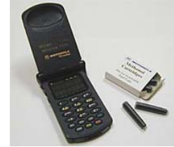
DMFC cellulare, il refill di metanolo avviene con cartucce
