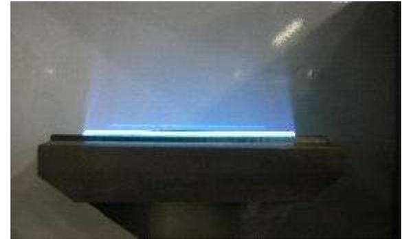
**La fiamma in genere è ottenuta in un bruciatore laminare che utilizza una miscela di due gas, comunemente aria/acetilene.**
